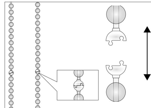
Dispositif de sécurité par ouverture automatique de la chaînette
