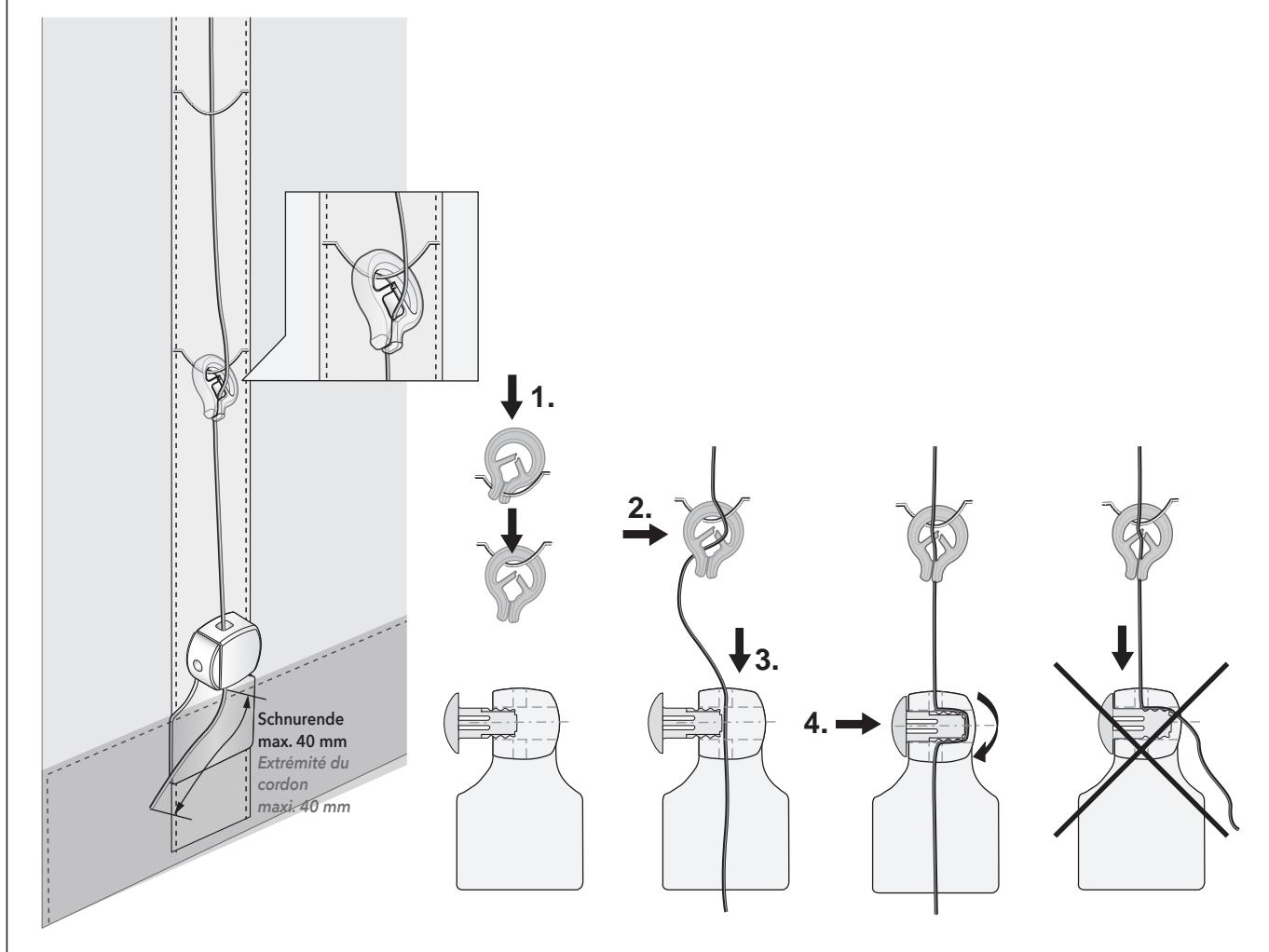
Achtung: Aufzugsschnur darf nicht verknotet oder verschmolzt werden, so das eine Verdickung entsteht, da sonst ein Auslösen in einer Gefahrensituation nicht sichergestellt ist.
