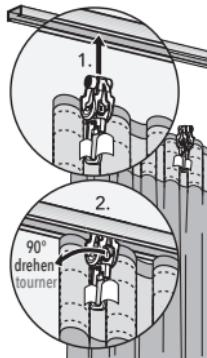
MHZ Rollringe und MHZ Gleiter können ganz einfach an jeder beliebigen Stelle in den Lauf der Stange oder Schiene ein- und auch wieder ausgedreht werden. Nutzen Sie diesen Vorteil, indem Sie Ihre Vorhänge in noch feuchtem Zustand bequem aufhängen.
