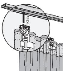
MHZ Clips-Gleiter können an jeder beliebigen Stelle ganz einfach in den Lauf der Stange oder Schiene eingeclipst werden. Nutzen Sie diesen Vorteil, indem Sie Ihre Vorhänge in noch feuchtem Zustand bequem aufhängen.
