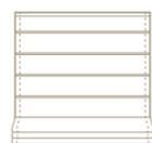
**Les raidisseurs à l'arrière** stabilisent parfaitement le store bateau dans sa largeur grâce aux fourreaux cousus au dos du store dans lesquels ils s'insèrent. Ils contribuent à former des plis compacts et homogènes.
