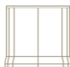
**Les rubans à passants** sont fixés au mécanisme à l'aide d'un ruban auto-agrippant. Le bord inférieur du store bateau est pourvu d'un ourlet dans lequel s'insère un profilé de lestage pour un tombé optimal.
