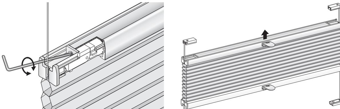
Le dispositif de compensation (avec plus-value) est possible en option à partir d'une largeur de store de 120,1 cm. À partir d'une largeur de store de 150,1 cm, le dispositif de compensation (avec plus-value) est à intégrer et n'est possible qu'avec le profilé Maxi (sans plus-value). Équipement ultérieur possible seulement en usine.
