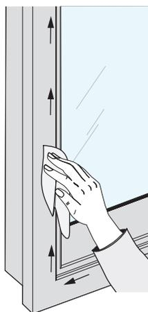
2. Den Primer-Stift in der Mitte knicken, um die innenliegende Kartusche aufzubrechen. Anschließend den Primer am Rand des Fensterrahmens entlang aufbringen.
