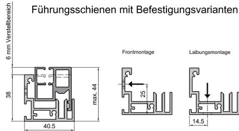
**Tabelle Befestigungspunkte Basisprofil für Direktmontage**
