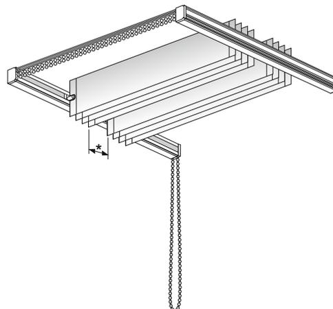
\* Lichtspalt bei Lamellen mit 127 mm: 11 cm
