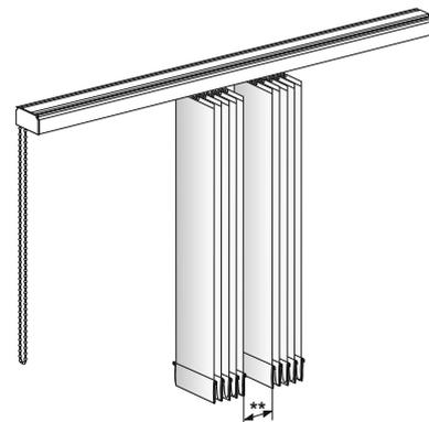
\*\* Lichtspalt bei Lamellen mit 127 mm: 11 cm
