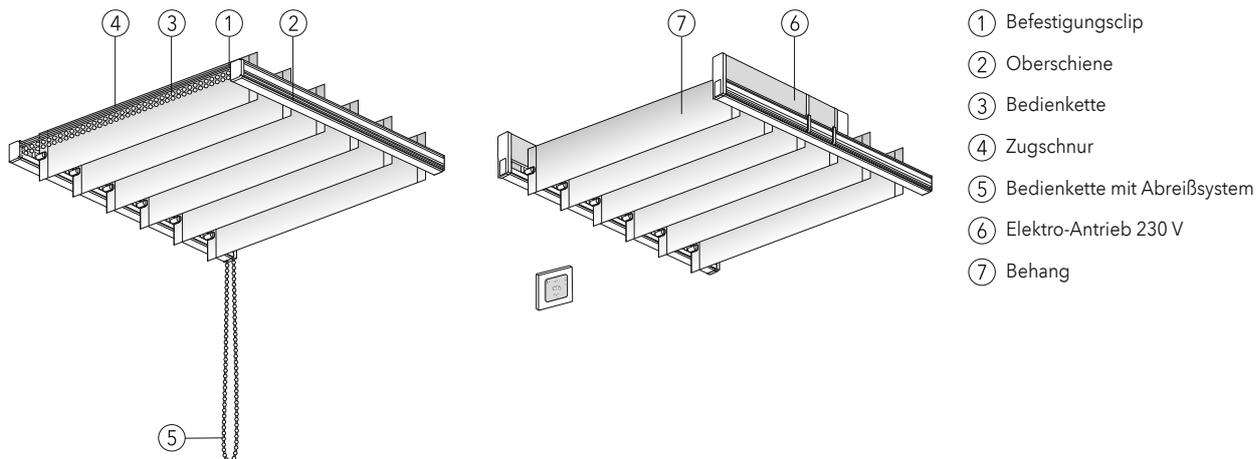
Öffnen und Schließen des Behanges durch Zugschnur nur oben an der Anlage möglich.
