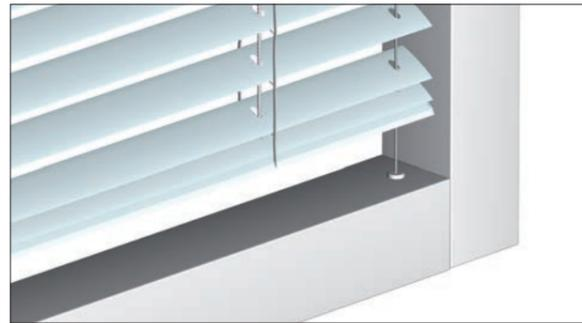
MHZ InLine erweist sich im Großen wie im Kleinen als schöner Blickfang. Die Montageschrauben werden durch die in das Kopfprofil eingeschobenen Lamellen verdeckt.
