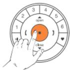
Appuyer sur le **bouton STOP** → Le rétroéclairage de la télécommande clignote pendant 6 secondes. La télécommande est en mode programmation.
