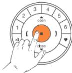
Premere il **tasto stop** per 6 sec. o attendere 20 sec. → I tasti del trasmettitore smettono di lampeggiare. Configurazione terminata.
