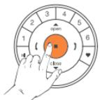
Premere il **tasto stop** per 6 sec. → I tasti del trasmettitore lampeggiano. Dispositivo in attesa di configurazione.
