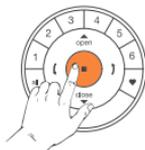
Premere il **tasto stop** per 6 sec. → I tasti del trasmettitore lampeggiano. Dispositivo in attesa di configurazione.
