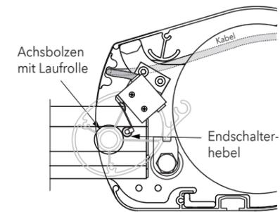
8. Auf Kabelführung achten (darf nicht an Seilscheibe streifen, Kabel mit Kabelbinder fixieren)
