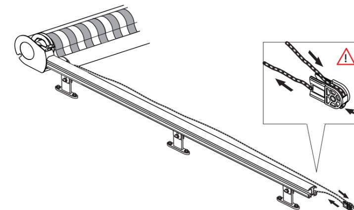
3. Seillänge und Knoten überprüfen (beidseitig 30 - 35cm von Kante Bodenprofil, Seilende darf max. 1-2 cm nach dem Knoten überstehen, aber auch nicht weniger)
