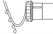
Um zu verhindern, dass Wasser in den Motor hineinläuft, sollte das Anschlusskabel immer mit einer Schleife nach unten verlegt werden.
